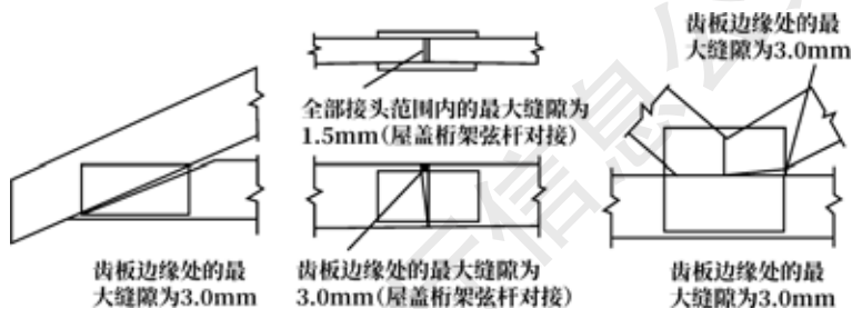
图 6.3.3-2 齿板桁架木构件间允许缝隙限值
